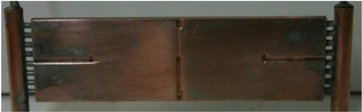
Figura 5.0.5 – Foto inferior da seção de testes (onde será acoplado o *cooler* Peltier)
